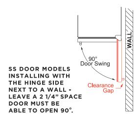
IF THE DOOR CAN'T OPEN FULLY -YOU CAN'T PULL THE SHELVES OUT AND RISK DAMAGE TO THE DOOR GASKET.
